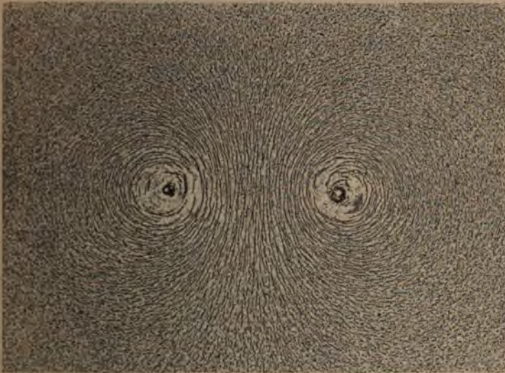
Abb. 152. Magnetisches Feld zweier Ströme von entgegengesetzter Richtung.
